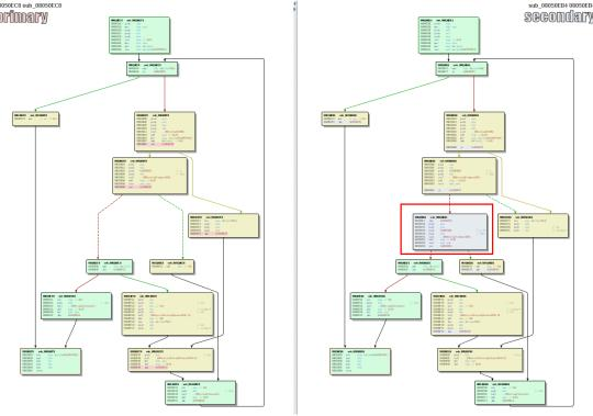
由于代码一次扫描 4 字节的逻辑,存在过滤遗漏,修复后的函数增加了对字符串中"."的校验且对".."的校验更加严格,结合上下文,可以推断出此函数是过滤与检测目录遍历字符的:
