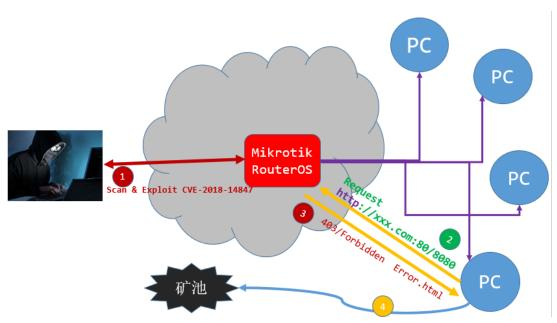
自从 CVE-2018-14847 三月份曝光以来,便有大量基于该漏洞利用的攻击,比如前段时间我们分析的 <u>VPNFilter 僵尸网络</u>,也是利用该漏洞作为最初的路由器感染向量,然后近段时间我们也观察到攻击者利用该漏洞发动多起基于
