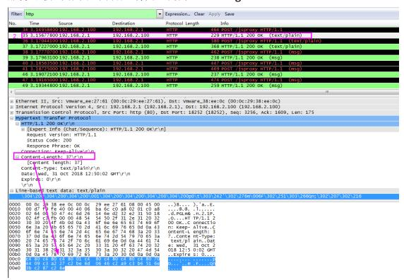
3. 客户端利用输入的账号密码采用 MS-CHAPv2 算法生成通信 key, 再利用这个 key 结合收到的提问内容 challenge 结合 RC4 加密生成 Reponse (应答), 发给服务器:
