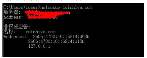
结果发现该域名无法被我们的运营商 DNS 解析,而是解析到本地,因此这样发起请求的时候会被拒绝(运营商 DNS 问题),当翻墙的时候是可以解析到的,为了测试的方便,我们没有去寻找可用的 DNS,而是再次修改利用代码中的挖矿脚本链接,使其指向我们自己搭建的 web 服务器(这样解析的时候就能正常访问而不影响测试)再次重新感染路由器:
